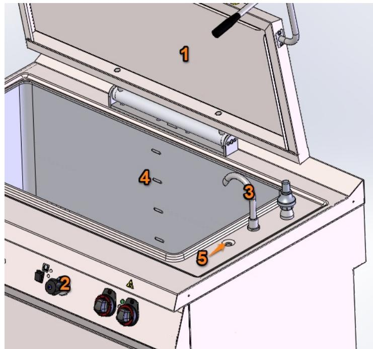
Avant de commencer à faire bouillir, il faut d'abord vérifier le niveau d'eau dans le duplicateur en ouvrant le robinet de trop-plein. Si aucune eau ne sort du duplicateur, il est nécessaire de faire sortir l'eau en maintenant l'interrupteur à bascule. Lorsque l'eau commence à couler, fermer le robinet de trop-plein. Note : Pour les versions AWF, sauter cette étape.
